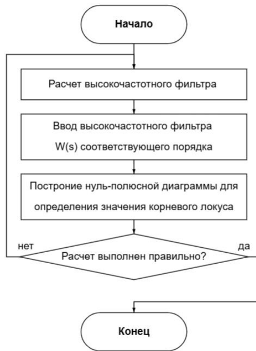
Рисунок 2.1 – Блок-схема алгоритма картирования корневых локусов системы высокочастотной фильтрации измерительного сигнала
